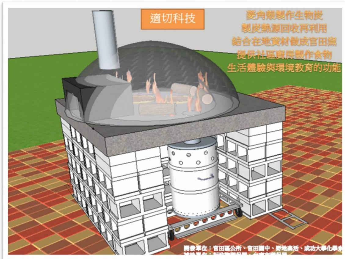
顏區長在與工作團隊不斷嚐試及研發下，運用孔洞材料及高溫低氧的上方點火法，成功打造菱角殼炭化設備—官田窯，並將製炭熱源回收再利用，提供民眾充分結合生活體驗及環境教育的功能（圖為臺南市官田區公所網站刊載官田窯示意圖）
