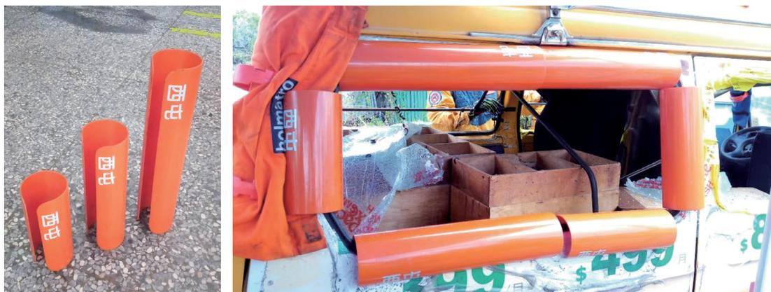
王柏寓隊員以方便取得的平價材料，自行研製「邊角防護套管」替代昂貴進口器材，運用於訓練與救災中提升車禍救援之安全性
